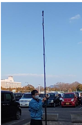
360度カメラを 高さ7mに設置
