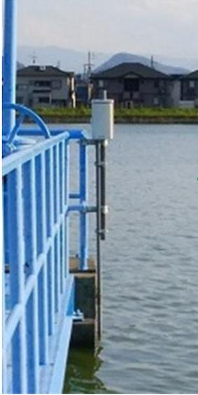
高松市ため池ハザードマップに掲載されているため池のうち、市街地に近く、かつ貯水量が多い、御厩池、大池(木太町)、久米池の3カ所に水位センサーを設置。基地局から最も遠い池(御厩池)までの距離は約11km。
