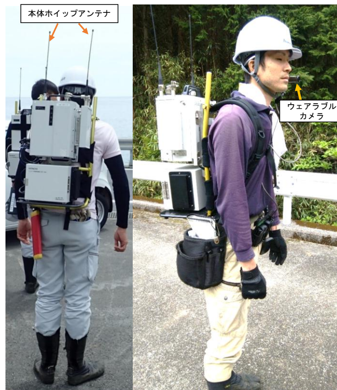
図 4 山中に入る調査員の装備の様子 (公共ブロードバンド無線機（移動局）: EMM-05BB-SLV を搭載)
